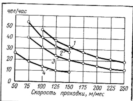
Рис. 2. Трудоемкость эксплуатации на 1 м тоннеля:
