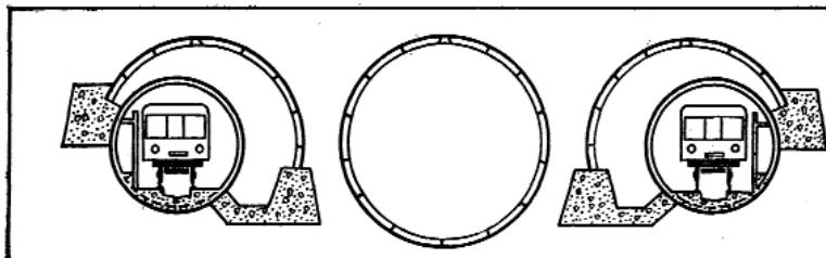
Выемка ядра и бетонирование лотков боковых тоннелей до обделок действующих перегонных. Монтаж каркасов путевых стен.
