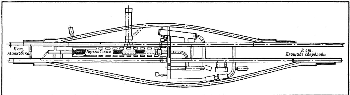
Рис. 2. План станции с обходными тоннелями.
