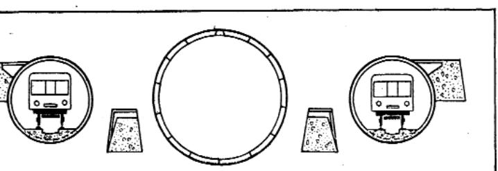
Бетонирование опор сводов боковых тоннелей.
