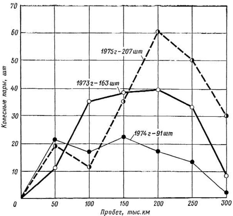
Рис. 4. Случайный ремонт подрезиненных колесных пар из-за неравномерного износа бандажей и дефектов резиновых вкладышей.
