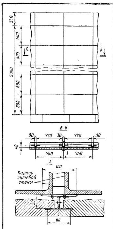
Рис. 10. Крепление облицовочных плит.
