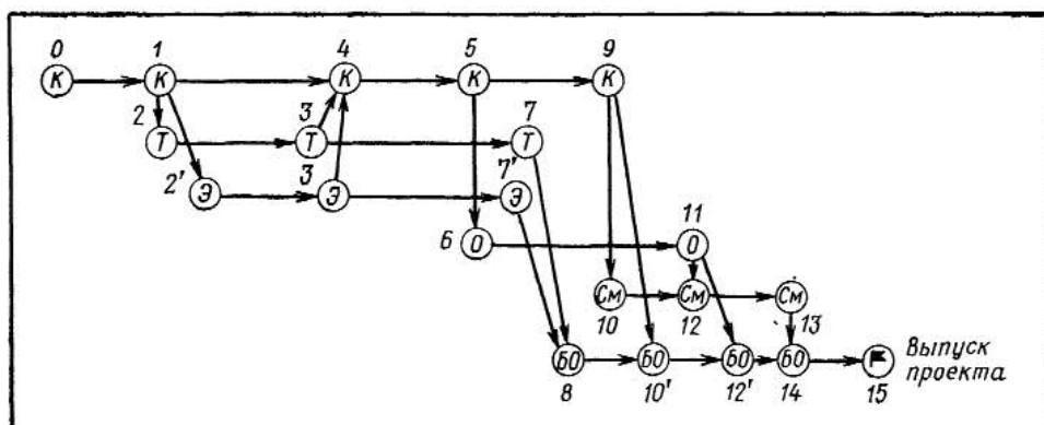
Рис. 2. Сетевая модель проектирования перегонных тоннелей метрополитена.
