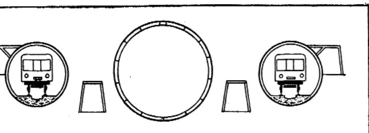
Проходка штолен под опоры сводов боковых станционных тоннелей.
