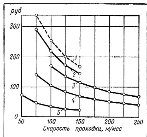
Рис. 1. Стоимость эксплуатации механизмов на 1 м тоннеля:
