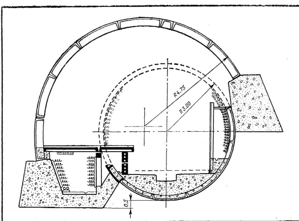
возведенные бетонные опоры. Работа велась с помощью специально изготовленных дуговых тюбингоукладчиков, приспособленных к конкретным условиям монтажа сводов в стесненной зоне (рис. 8);
