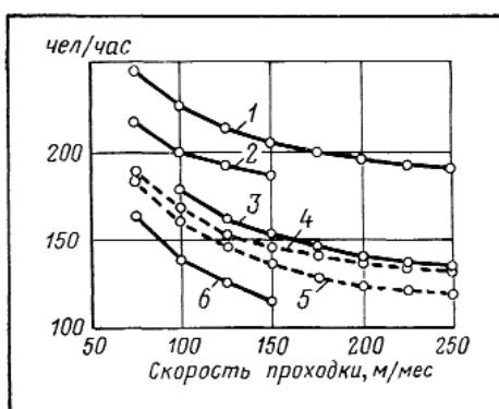
Рис. 6. Трудоемкость сооружения 1 м тоннеля:
