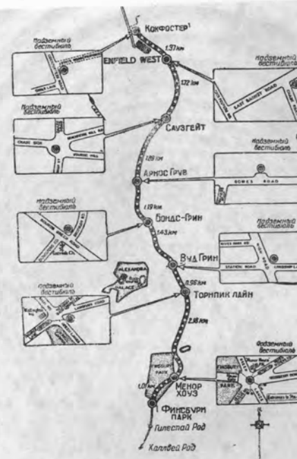
Рис. 37. Трасса последней линии Лондонского Эндерграунда „Финсбюри-Парк Кокфостер“, с показанием расположения подземных и надземных станционных вестибюлей.
